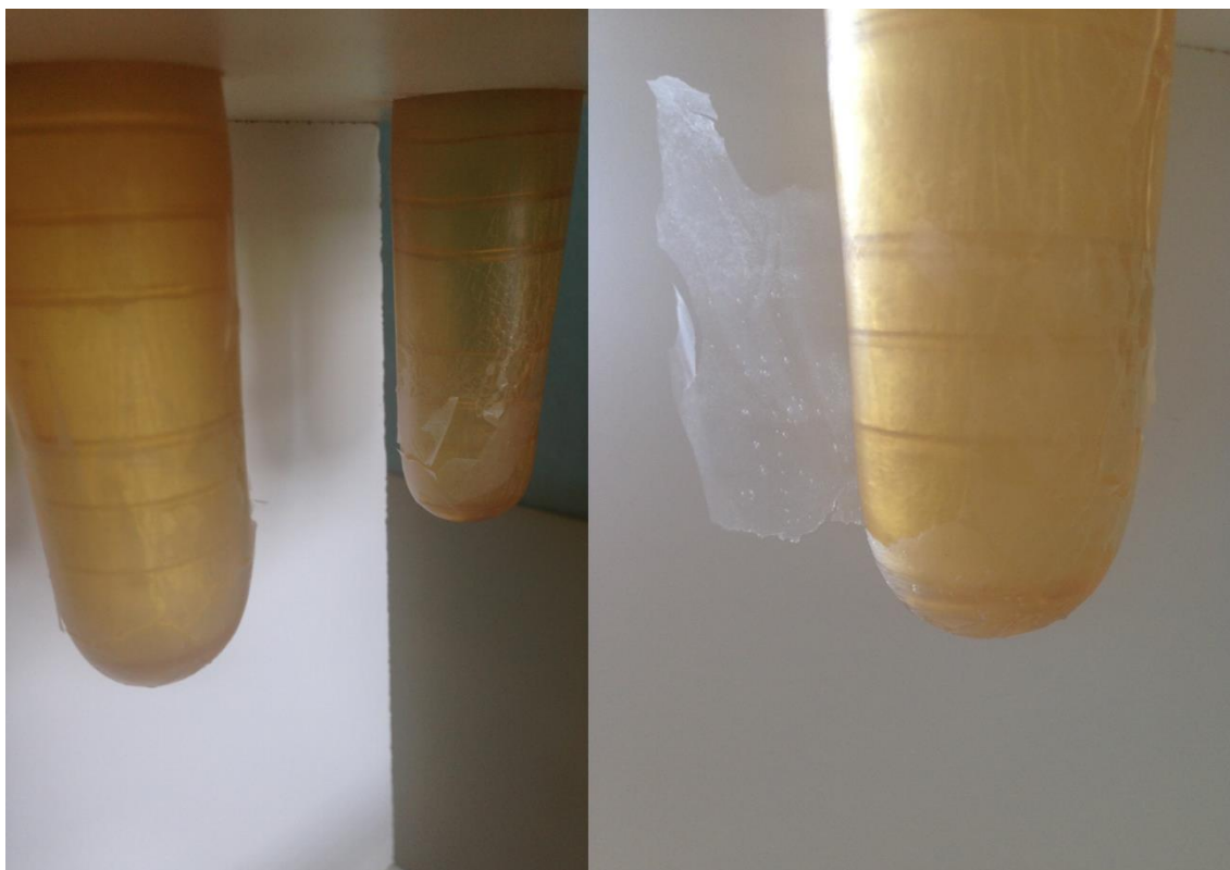
FIGURA 7 – Tetos de borracha após secagem da solução filmogênica de amido de mandioca.
