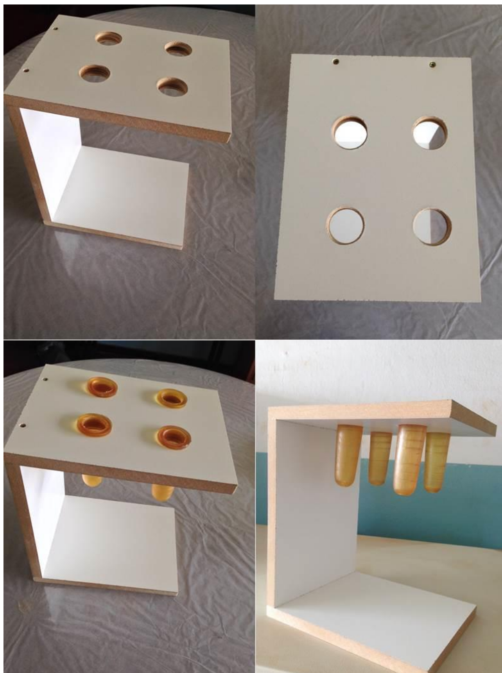
FIGURA 4 – Suporte e tetos de borracha utilizados para avaliação da adesividade da solução filmogênica de amido de mandioca.
