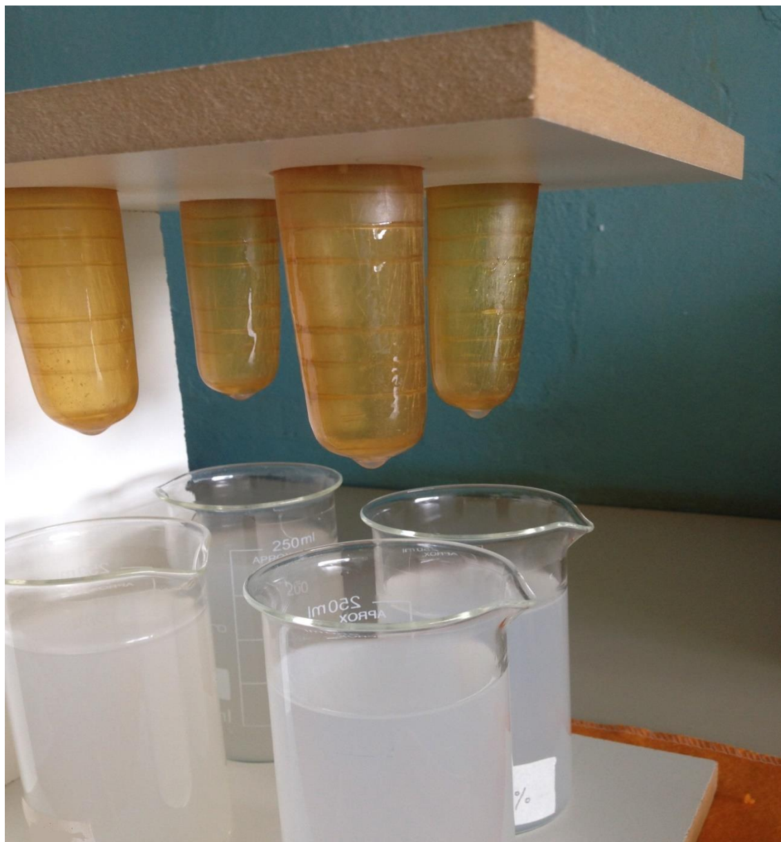
FIGURA 6 – Tetos de borracha após imersão em soluções filmogênicas de amido de mandioca.
