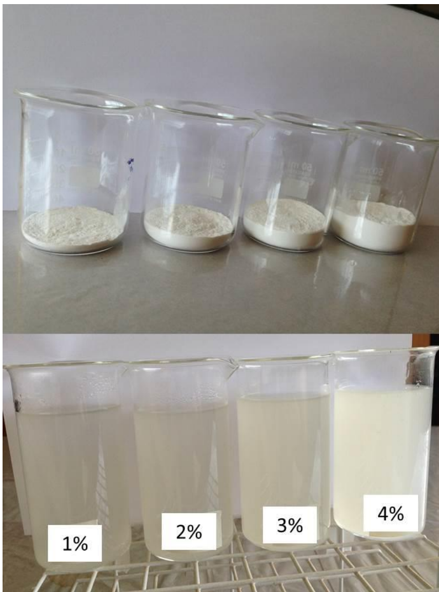
FIGURA 5 – Amido de mandioca in natura (1) e solução filmogênica de amido de mandioca (2) em diferentes concentrações.
